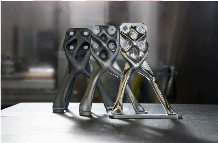
Partie de la structure en aluminium du télescope EXCITE. La forme courbée et croisée de la structure permet d'augmenter la résistance à certaines forces excentrées.
